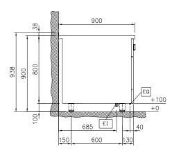
Electrical inlet (power) EQ **Equipotential screw**
